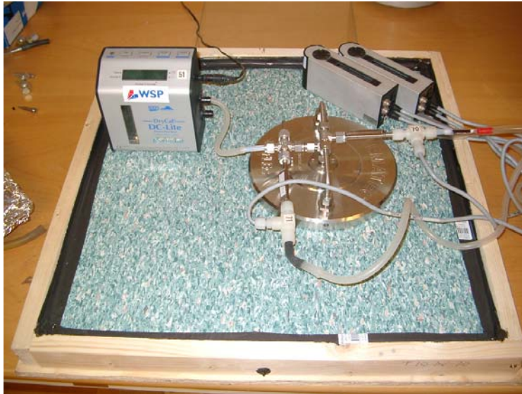
Bild: Emissionsmätning med FLEC-utrustning.
